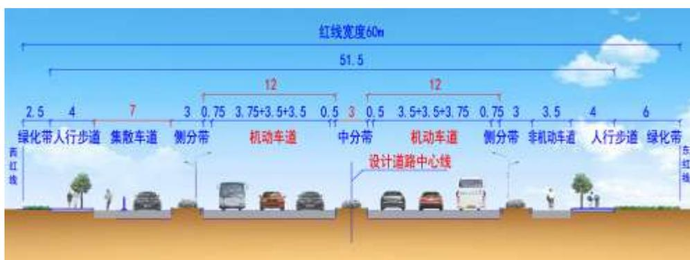
图 2-1 起点至北堤路段（K0+000~K1+756）横断面
