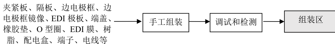
图 5 EDI 膜块组装工艺流程及产污环节
