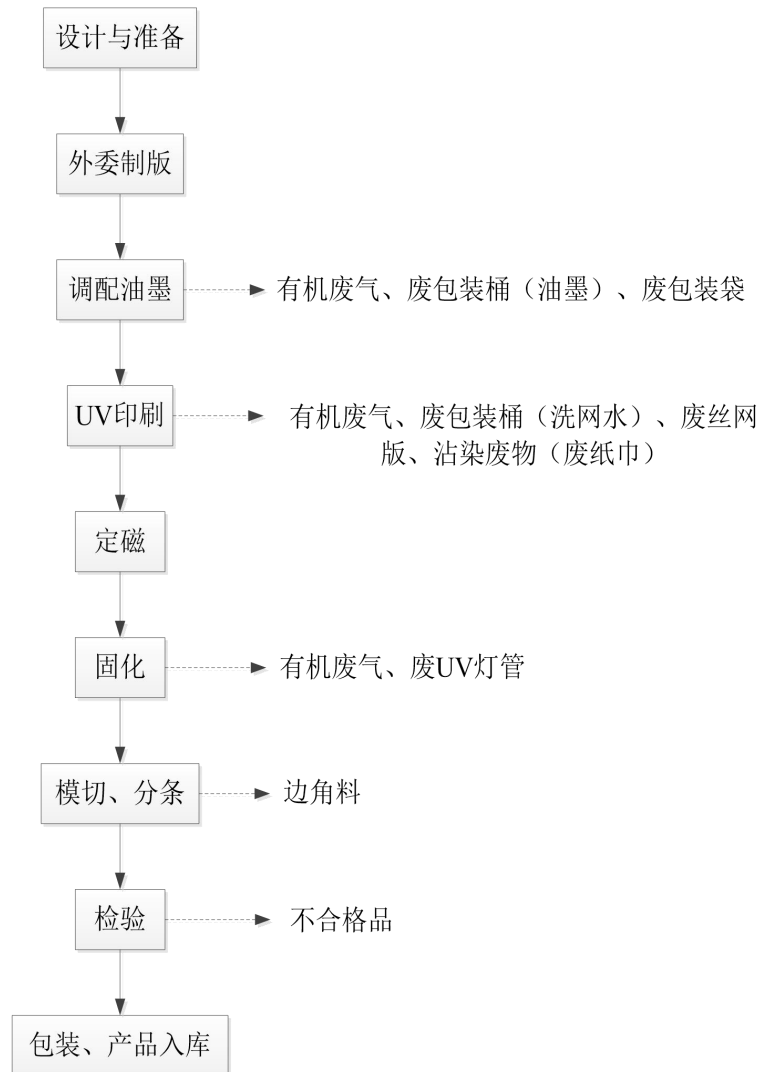
图 5 新型防伪标识的生产工艺流程及产污环节图
