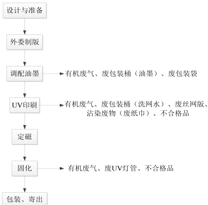
图 6 新型防伪标识的研发工艺流程及产污环节图
